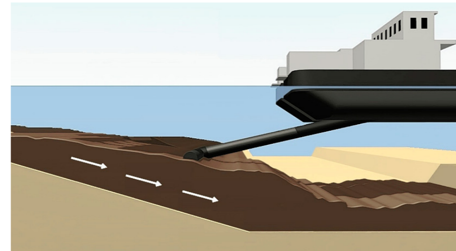
Schematisch overzicht van een WID-schip dat slib onder een hoek laat stromen. (Bron: Baggerbedrijf De Boer)
